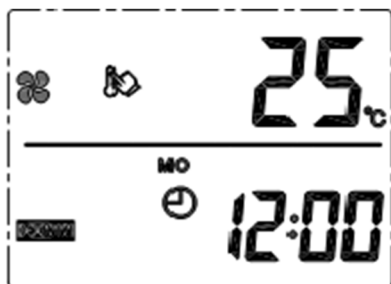
Настройка температуры SA (приток)
